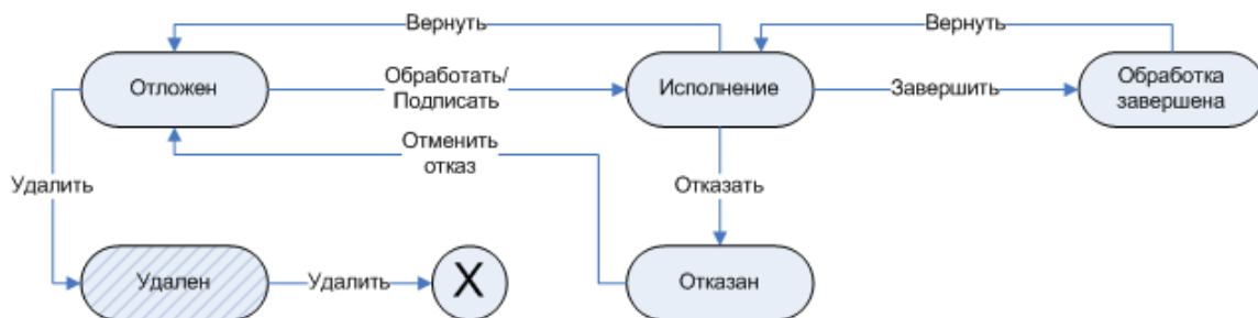
Рис. 13. Схема обработки ЭД «Иск» и «Претензия»
